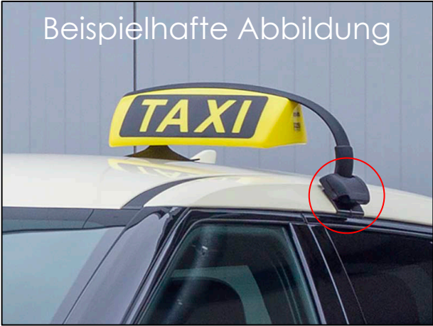
Halterung für HALE Dachzeichen
