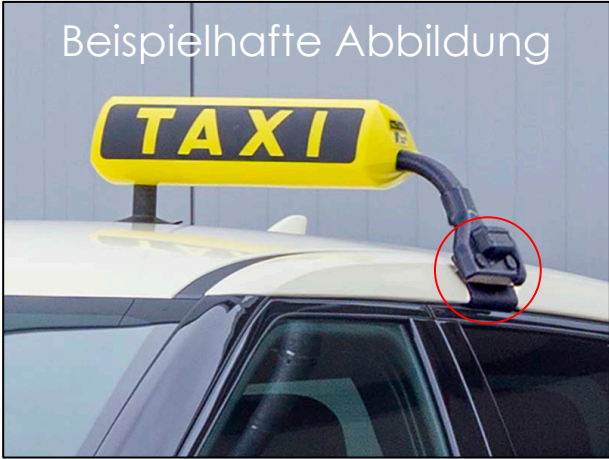
Halterung für Kienzle Argo Dachzeichen
